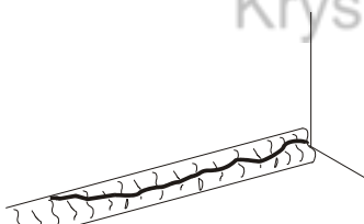
Pęknięcie połączenia spawanego
